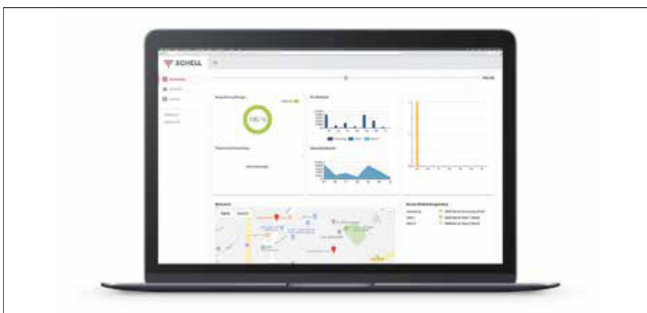
Abbildung 5: Mit einem Online-Service ist ein globaler Fernzugriff auf einzelne Armaturen, ganze Trinkwasserinstallationen und sogar mehrere Liegenschaften gleichzeitig möglich.
