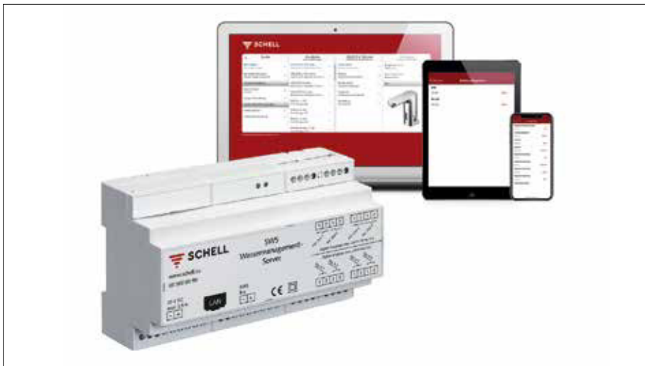
Abbildung 3: Über den Server des Wassermanagement-Systems lassen sich alle elektronischen Armaturen vernetzen und steuern. Darüber können beispielsweise Stagnationsspülungen an mehreren Armaturen zeitgleich ausgelöst werden.
