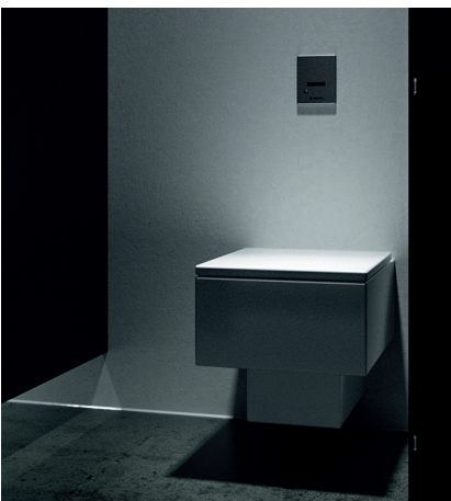
Bild 3: Bei einer ohnehin vorhandenen Anschlussleitung von mindestens \frac{3}{4} " sind berührungslose Druckspüler aus hygienischen Gründen immer die erste Wahl: Sie erfüllen Geräuschkategorie I, verfügen über eine Zwei-Mengen-Sparfunktion und Stagnationsspülung, sorgen für hohe Spülgeschwindigkeiten in den Leitungen und „bevorraten“ kein Wasser, welches möglicherweise kontaminiert ist. Foto: Schell
